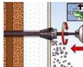
4. Säubern Sie das Loch ordentlich mit einer Bürste oder mit Druckluft um anschließend eine Siebhülse einzufügen. (Je nach Material)
