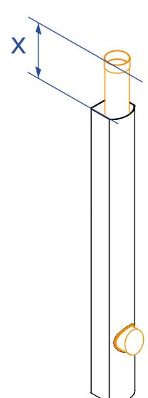
8.3 Überstand des Fallrohrs oberhalb der Stütze messen. Fallrohr vom Bogen trennen und aus der Stütze nehmen.
