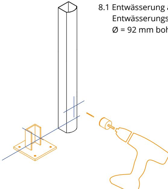
8.1 Entwässerung anzeichnen und Entwässerungsloch mit Lochsäge  $\varnothing = 92 \text{ mm}$  bohren.
