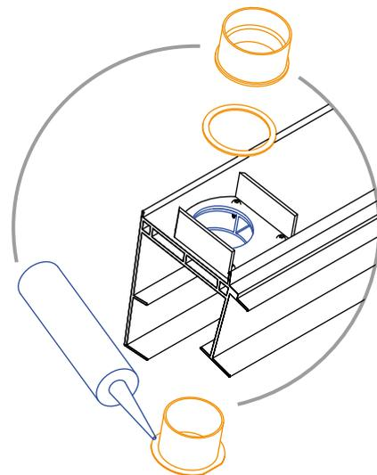
3.3 Ablaufstutzen fertig montiert
