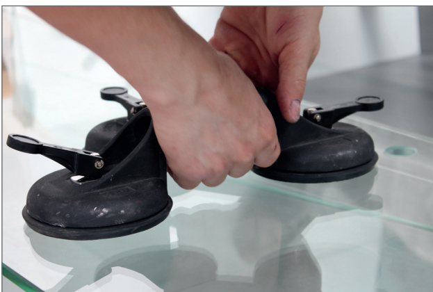
Einsatz eines Glassaugers
