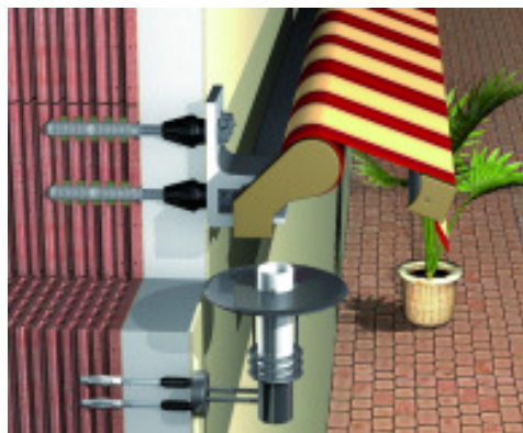
fischer Thermax dient zur wärmebrückenfreien universellen Befestigung von Gegenständen in WDVS.
